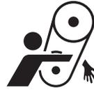
Berühren Sie niemals während des Betriebs die beweglichen Teile des Motors und lassen Sie Ihre Kleidung nicht mit ihnen in Berührung kommen. Wenn ein Körperteil oder ein Kleidungsstück von der vorderen Antriebswelle, dem Keilriemen, der Propellerwelle usw. erfasst wird, kann dies schwere Verletzungen zur Folge haben. Achten Sie darauf, dass kein Werkzeug, keine Lappen usw. auf dem Motor oder in unmittelbarer Nähe des Motors zurückgelassen werden.
