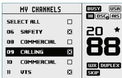
Bei anschließendem Öffnen dieser Seite werden nur die ausgewählten Kanäle angezeigt. Durch Auswahl einer Kanaloption wird die Seite sofort verlassen und das Funkgerät auf diesen Kanal eingestellt.
