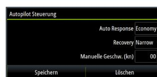
Diese Option ermöglicht die manuelle Änderung von Parametern, die während der Inbetriebnahme des Autopilot-Computers eingestellt wurden. Weitere Informationen zu den Einstellungen finden Sie in der separaten Dokumentation für den Autopilot-Computer.
