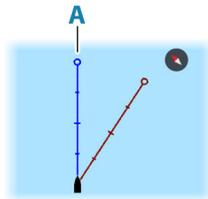
Richtet die Karte so aus, dass der Steuerkurs des Schiffes (**A**) nach oben zeigt. Die Informationen zur Fahrtrichtung werden von einem Kompass bezogen. Ist keine Fahrtrichtung verfügbar, wird der Kurs über Grund (COG) vom GPS verwendet.
