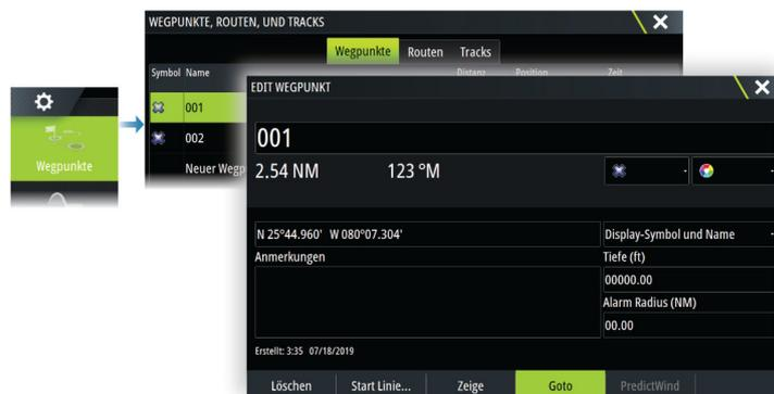
Wenn Sie zu einem Wegpunkt navigieren, wird das Menü erweitert und zeigt Optionen zum Abbrechen und Neustarten der Navigation von der aktuellen Schiffsposition aus an.
