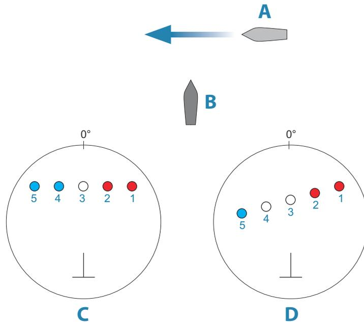
Die Beispiele zeigen die Bewegung des Ziels (1-5) über 5 Radarmessungen mit dem Radar im Modus "Relative Bewegung".
