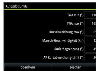
Diese Option ermöglicht die manuelle Änderung von Parametern, die während der Inbetriebnahme des Autopilot-Computers eingestellt wurden. Weitere Informationen zu den Einstellungen finden Sie in der separaten Dokumentation für den Autopilot-Computer.
