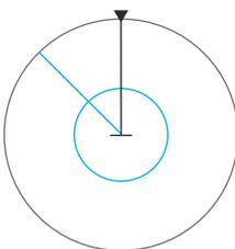
Mit der elektronischen Peillinie (EBL) und dem variablen Messring (VRM) können Sie schnell zu allen Schiffen und Landmassen im Radarfeld die Distanzen und Peilungen messen. Es können zwei verschiedene EBL/VRMs auf dem Radarbild platziert werden.
