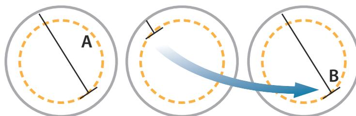
Wenn echte Bewegung ausgewählt wird, kann die Reset-Option für diesen Modus über das Menü aktiviert werden. Dadurch sind Sie in der Lage, das Radarbild manuell zurückzusetzen und das Schiffssymbol wieder in der anfänglichen Position zu platzieren.
