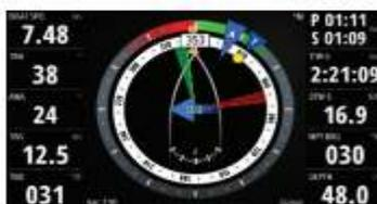
SailSteer bietet eine zusammengefasste Ansicht der wichtigsten Fahrtdaten. Alle Daten, die in Relation zum Bug der Yacht angezeigt werden. Die Anzahl der Datenfelder, die in dieser Anzeige eingeschlossen sind, ist von der verfügbaren Feldgröße abhängig.
